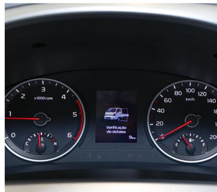
O Bongo 4x4 possui painel dianteiro com detalhes na cor cinza e odômetro digital com medições parciais A e B e conta-giros, além de computador de bordo e indicação do nível de ureia, com controle no volante.
