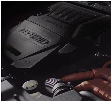
O Kia Niro está equipado com motor Kappa PE 1.6L híbrido HEV com Injeção Direta (GDI), 4 cilindros, à gasolina, capaz de gerar 141 cavalos de potência combinada e torque de 27 kgf/m.
