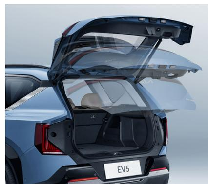
O Kia EV5 conta com tampa do porta-malas com acionamento elétrico e abertura programável (Smart Tailgate) pela chave inteligente (Smart Key).
