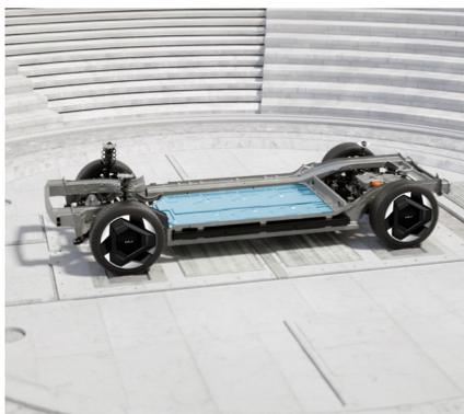
Bateria de alta tensão de Fosfato de Ferro e Lítio (LFP), com estrutura tipo lâminas, com capacidade total de 88,16 kWh e carregamento rápido de 30% a 80% em 27 minutos em corrente contínua (DC) de 360 kW ou de 83 minutos em estação de 50 kW.
