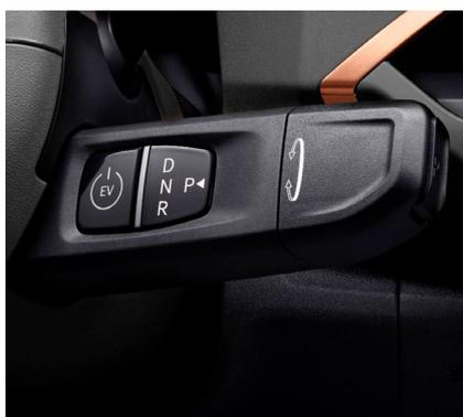
O posicionamento da alavanca de câmbio na coluna do volante aumenta o espaço interno e melhora a comodidade ao dirigir.
