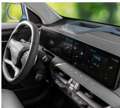
Display panorâmico com telas integradas do painel digital de instrumentos de 12,3", do cluster central de 5,3" e do multimídia de 12,3", com comandos sensíveis ao toque.
