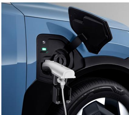
O Kia EV5 vem equipado com conectores de carregamento A/C (Tipo 2) e D/C (Tipo CCS) e carregador de emergência de baixa potência (A/C - Tipo 2).
